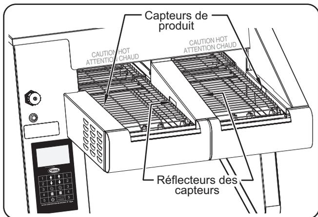
Capteurs de produit et réflecteurs des capteurs
