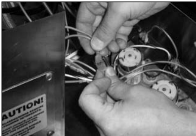
Unhooking motor power wire
