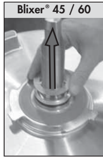
13) Remove 1 mm thick washer
