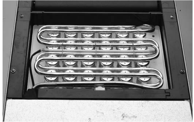
Pour Scale Remover Over The Evaporator Section
