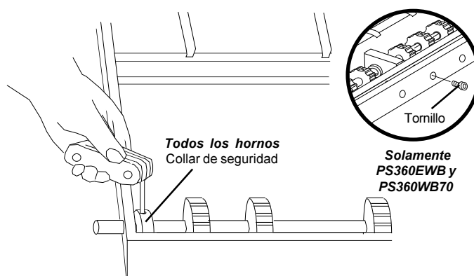
Figura 4-7 - Eje impulsor de banda doble
