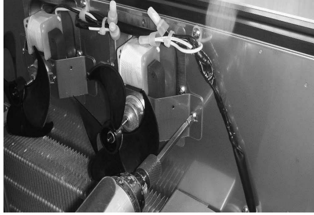
B.Remove the evaporator fan motor
